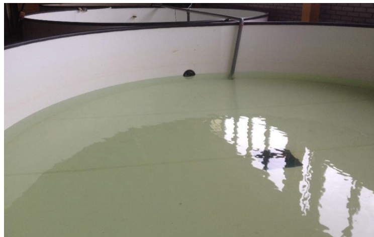
Figuur 3.2. De HDPE bakken waar het roterende systeem in geplaatst kan worden.
